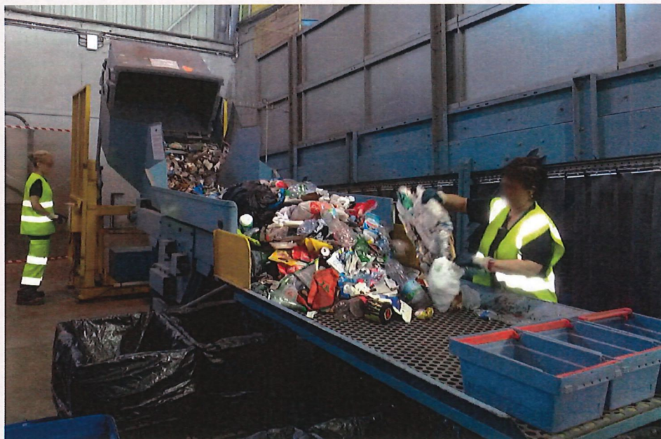
Caractérisation au centre de tri du Muy (Analyse d'un échantillon de déchets prélevés sur une collecte de bacs jaunes)
