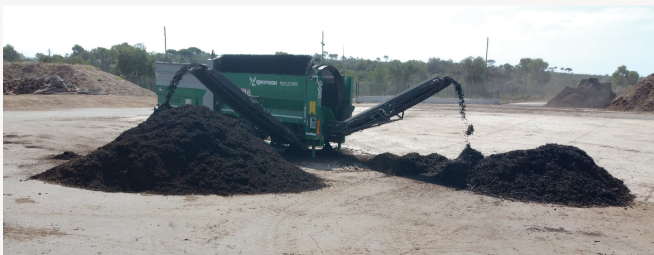
Criblage du compost
